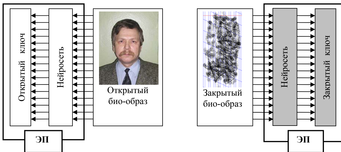
Рис. 1. Нейросетевое связывание открытых (общедоступных) биометрических образов человека с его открытым ключом и связывание тайных биометрических образов человека с его закрытым ключом.
